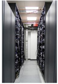
1 стойка = 256 узлов: Intel Xeon (14c) + NVIDIA K40= 515 Tflop/s Суперкомпьютер "Ломоносов-2" = 2,9 Pflop/s
