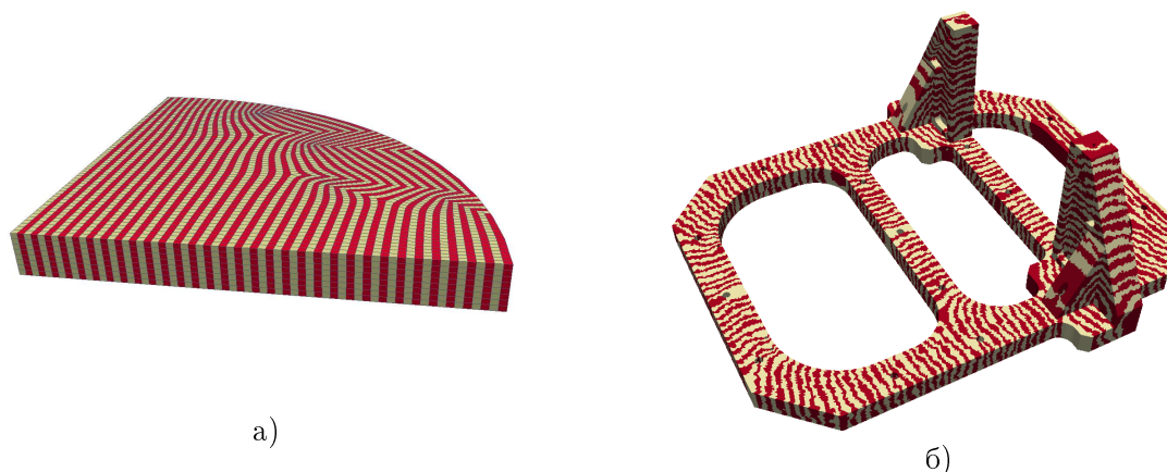
Рис. 2: Слои для неструктурированных сеток: а) из шестигранных ячеек, m = 31744 , n_s = 64 ; б) из четырехгранных ячеек, m = 485843 , n_s = 137
