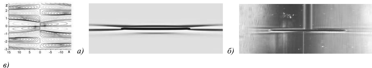
Рис. 4. Расчет и теневая визуализация течения, индуцированного диффузией, на препятствии с горизонтальными границами: а) – картина линий тока на полосе; б, в) – расчет и теневая визуализация поля градиента плотности около горизонтального диска в лабораторном бассейне.
