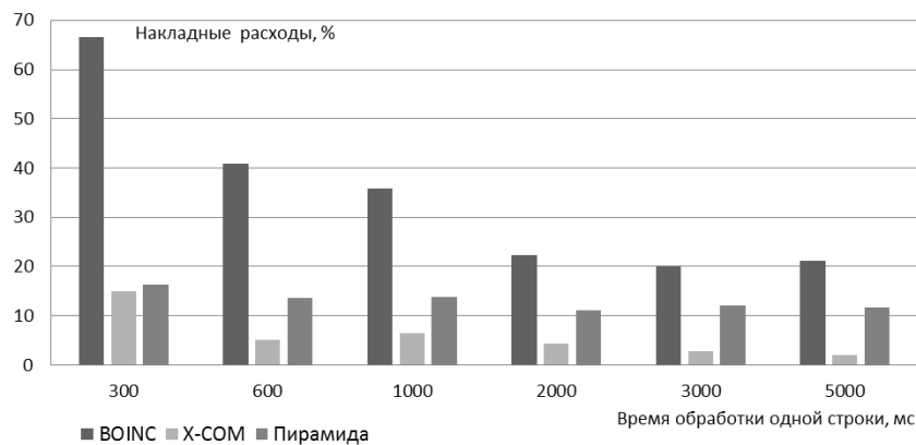
Рис. 6. Накладные расходы для тестового примера Opp_file при переменном времени обработки одной строки, N = 10^5 строк, p = 56
